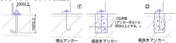
コンクリート基礎の高さとアンカーボルトの適用例 パイプ使用の場合)
