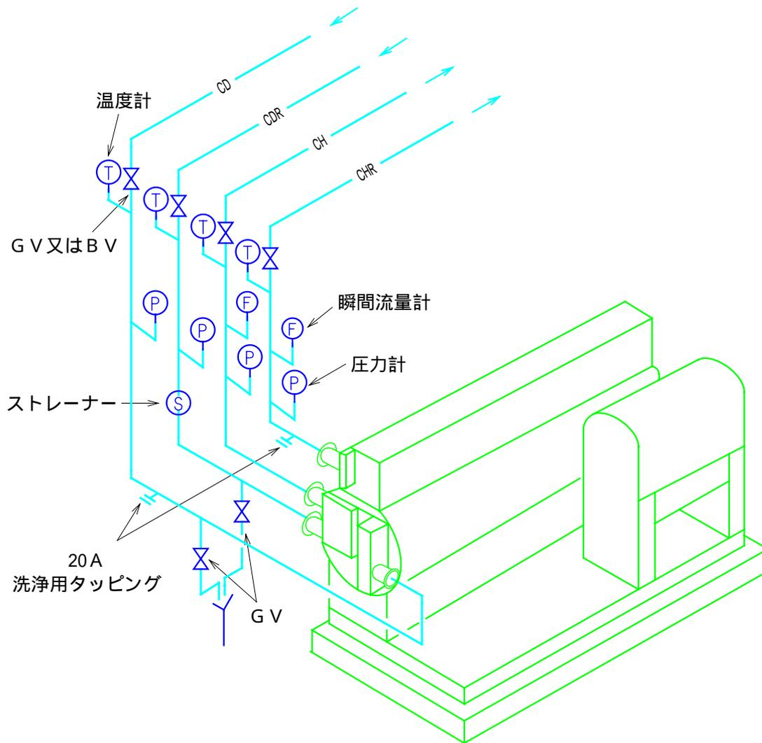
注 形鋼振れ止め支持、固定は、機器廻り配管吊り及び支持要領(一)参照。
