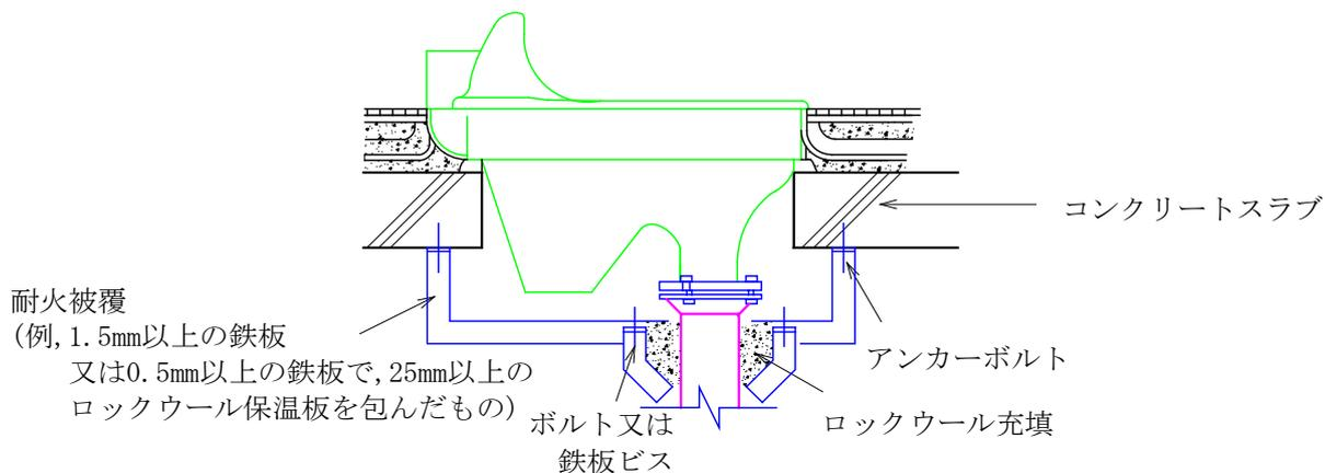
(2) 耐火カバーを使用する場合 (建築基準法令に適合する工法とする。)
